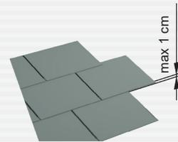
Permet de joindre la fenêtre avec des couvertures en ardoise jusqu'à **1 cm** d'épaisseur (2x0,5 cm) En tôle d'aluminium revêtue de polyester.
